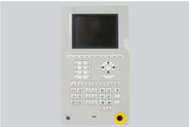
01 采用进口塑机专用电脑，CPU 分工控制处理，多组模具成型资料储存功能，多点 PID 料温控制、注射、预塑、开合模动作采用高精度电子尺控制，提高控制系统响应速度及稳定性。
